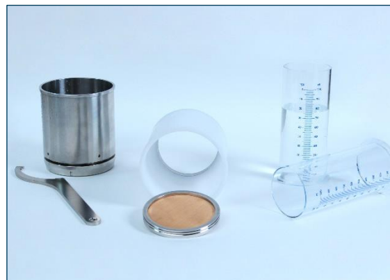
Komory drenażowe i zlewki pomiarowe
