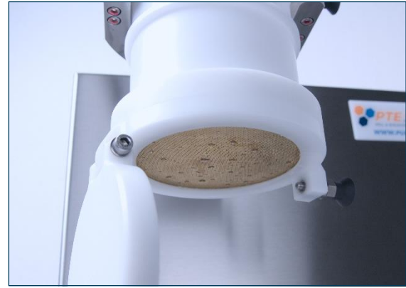
Nach Norm kalibriertes CSF Sieb
