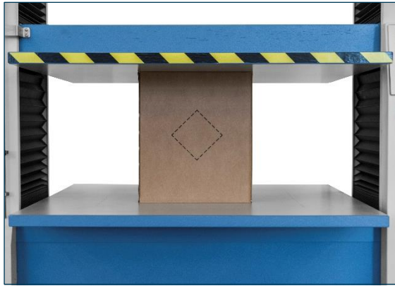
Probe zwischen den Platten zentriert
