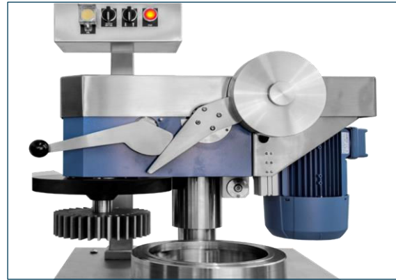
Górna część obrotowa, łatwy dostęp do naczynia mielącego
