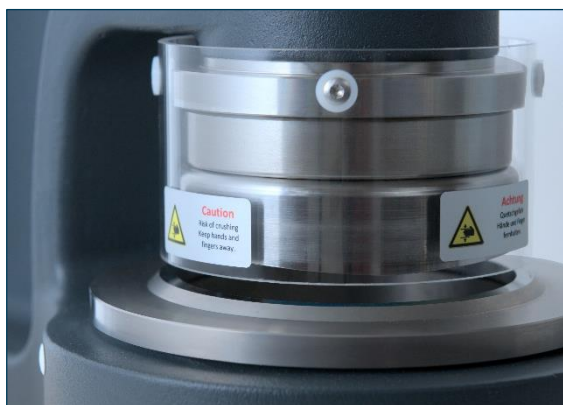
Sicherheitsabdeckung des Stanzbereichs
