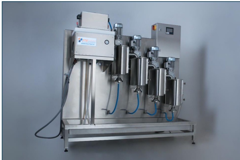
Bauer Mc Nett Gerät kombiniert mit Somerville, kundenspezifische Lösung (besondere Anordnung des Schaltkastens)
