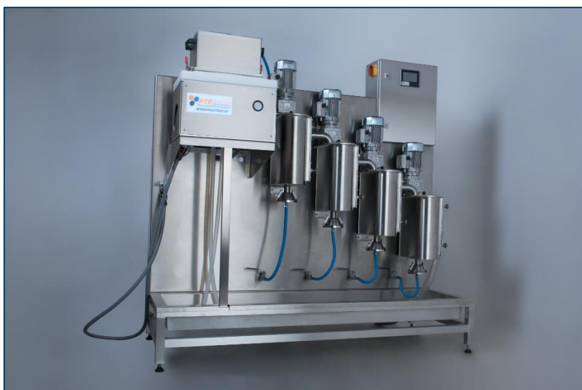
Urządzenie Bauer Mc Nett w połączeniu z Somerville, rozwiązanie niestandardowe (specjalny układ skrzynki kontrolnej)
